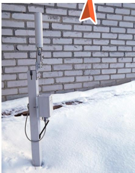
Возможность оперативного изменения угла наклона приемного и передающего блоков позволяют менять форму и свойства зоны обнаружения.
