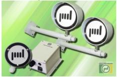
**Призма-3...Б** - В комплект входят коробка соединительная для подключения передающего блока извещателя, с управлением литерами, и блок управления с органами настройки и индикации для подключения приемного блока извещателя с органами настройки и индикации. Подключение производится с помощью встроенных байонетных разъемных соединителей.
