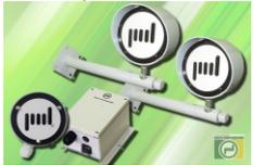
**Призма-3...Б** - В комплект входят коробка соединительная для подключения передающего блока извещателя, с управлением литерами, и блок управления с органами настройки и индикации для подключения приемного блока извещателя с органами настройки и индикации. Подключение производится с помощью встроенных байонетных разъемных соединителей.
